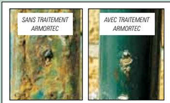
*Les tests démontrent que le poteau traité Armortec dure 5 fois plus longtemps qu'un poteau classique.*
