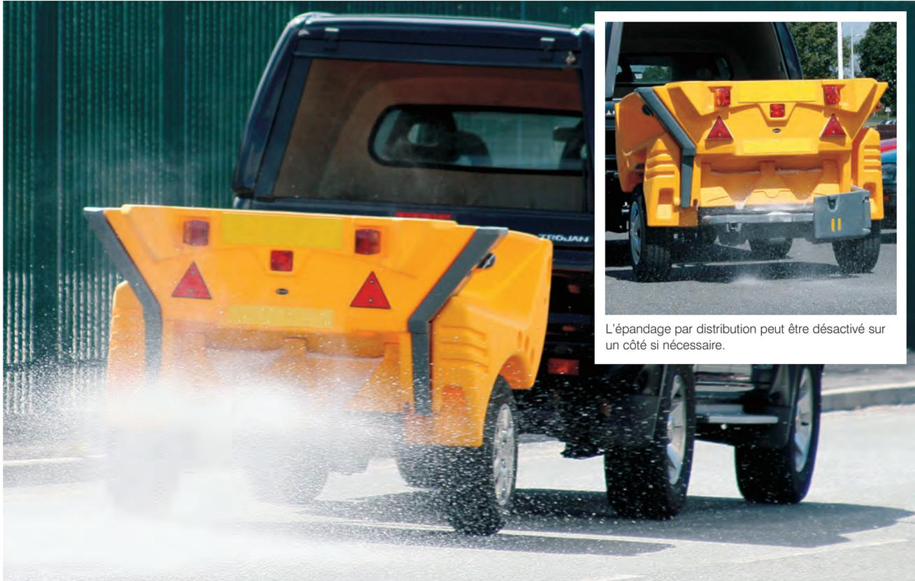
L'épandage par distribution peut être désactivé sur un côté si nécessaire.
