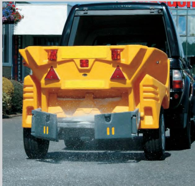
PASSEZ D'UN ÉPANDAGE PAR PROJECTION À UN ÉPANDAGE PAR GRAVITÉ GRÂCE AUX DEUX DÉFLECTEURS LATÉRAUX.
