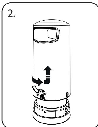
Tout en laissant la clé dans la serrure, faites pivoter le couvercle de la poubelle dans le sens contraire des aiguilles d'une montre et soulevez le couvercle au-dessus de l'insert.
