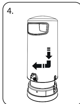
Pour fermer, soulevez le couvercle au-dessus de l'insert et reposez-le sur le couvercle. Faites ensuite pivoter le couvercle dans le sens des aiguilles d'une montre pour le verrouiller au socle.
