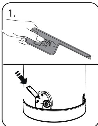
Pour ouvrir, assurez-vous que l'illustration sur la clé pointe vers le haut. Puis insérez la clé à fond dans la serrure. (Ne tournez pas la clé.) Le mécanisme de verrouillage est alors déverrouillé.
