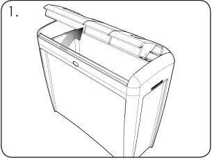
Soulevez le couvercle en utilisant le rebord qui se situe à l'avant des panneaux d'ouverture.
