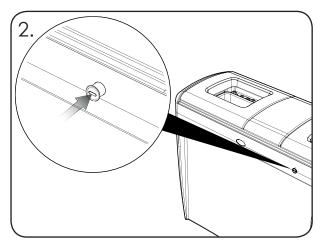
Pour verrouiller, tournez la clé à 45 degrés dans le sens antihoraire et poussez le barillet vers l'intérieur.
