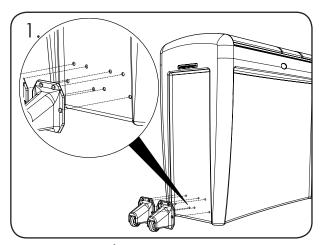
Alignez les roues (Élément 1) avec les orifices de fixation qui se situent sur les côtés du conteneur.
