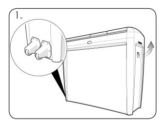
Utilisez la poignée pour soulever et incliner le conteneur jusqu'à ce que les roues entrent en contact avec le sol et que le conteneur puisse être déplacé.
