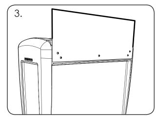
Placez les rondelles (Élément 2) sur les vis (Élément 3) et insérez-les dans les orifices qui se situent sur le panneau arrière à l'aide de la Clé Allen (Élément 4) avant de les serrer.
