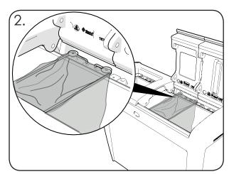
Etape 3 - Accrochez le sac sur le rebord arrière et maintenez-le en place à l'aide du cordon élastique. Etape 4 - Accrochez le cordon élastique et le sac sur le rebord avant, afin de fixer le sac.
