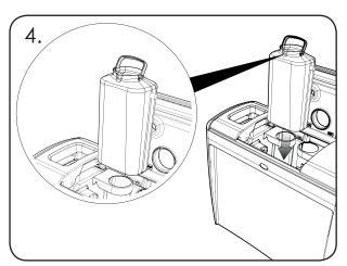
Replacez le réservoir en positionnant le bec verseur vers l'avant.
