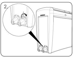
Insérez les vis (Élément 2) à l'intérieur des orifices et serrez-les à l'aide de la Clé Allen (Élément 3).
