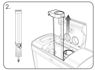
Soulevez le porte-gobelets pour l'extraire de son support de fixation. Utilisez le mécanisme de démontage rapide pour collecter les gobelets. Replacez le porte-gobelets sur son support de fixation.
