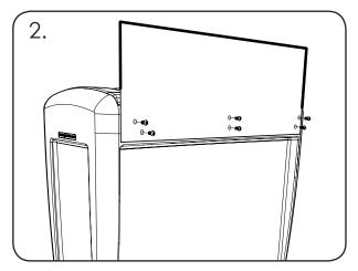
Positionnez le support de panneau (Élement 1) et alignez les six orifices de fixation qui se situent à l'arrière du conteneur.
