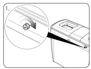
Pour déverrouiller, tournez la clé à 45 degrés dans le sens horaire jusqu'à ce que le barillet se rétracte.
